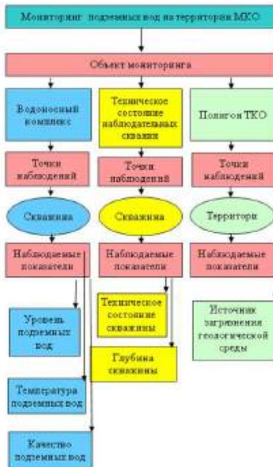
Рис.8.1 - Структура ведения мониторинга подземных вод на территории объекта проектирования ТКО
